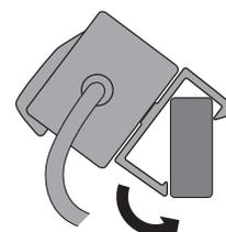
フックの上側の爪をパイプに引っかけ、回転させるように下に押し込んでください。
