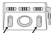
コードクリップを使用する場合は、C型クリップを重ねて取り付けてください。
