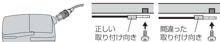
② 変換アダプターをセンターフレームのパイプに取り付けます。
