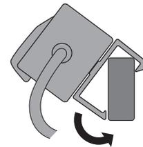
フックの上側の爪をパイプにひっかけ、回転させるように下に押し込んでください。
