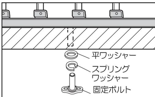
折りたたみサイドレールの挿し込み部の下側から固定ボルトで2箇所固定します。その際、左図のように平ワッシャーとスプリングワッシャーをはさみます。緩みのないようにしっかり締め付けてください。
