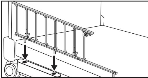
折りたたみサイドレールの挿し込み部を、ベッドのホルダーの穴に挿し込みます。
