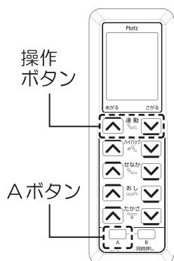
② 設定モードにて手元スイッチの最上段の操作ボタン 、 を押して表示画面の選択項目を移動させ、「メモリー」を選択した状態で、「A」ボタンを押してください。
