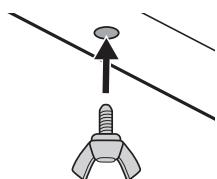
① ネジを外してアース線を取り外します。
