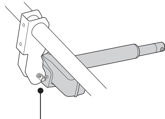
1. ピン先端の穴から抜け止めピンを抜きます。
