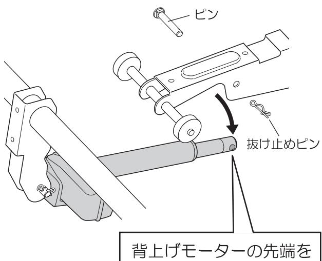
**3** 背上げモーター根元側のピンと抜け止めピンを外してください。
