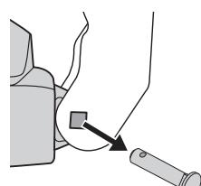
**4** 背上げモーターをベッドフレームから外し、背ボトムを下ろします。
