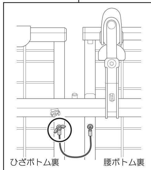
① ネジを外してアース線を取り外します。
