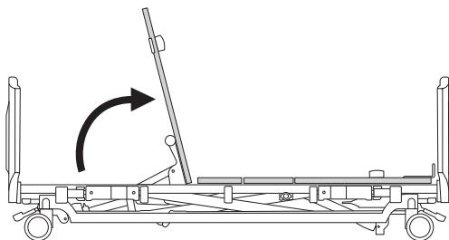
**2** 背上げモーター先端の抜け止めピンとピンを外してモーターの先端を下げてください。
